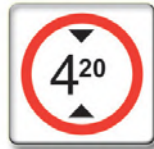
Altura libre restringida
